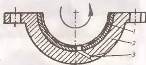
Рис. 3 Крышка шатуна в разрезе
